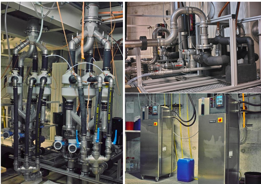
Abb. 3: Links: Das Befeuchtungssystem des Windkanals. In jedem Luftstrang befinden sich jeweils drei Nafion Befeuchter mit denen die Luft im Windkanal auf eine definierte Wasserdampfmenge befeuchtet werden kann (definierter Taupunkt). Dafür werden die Nafionröhren innerhalb eines Befeuchters von Wasser mit einer definierten Temperatur (diese entspricht der Taupunktstemperatur) umspült. Die drei Befeuchter eines Stranges befinden sich deshalb jeweils in einem geschlossenen Wasserkreislauf (Bild rechts oben), der durch jeweils eine Pumpe betrieben wird. Darin befindet sich jeweils ein Wärmetauscher, der mit jeweils einem Thermostat (Huber Kältemaschinenbau AG) verbunden ist (Bild rechts unten). Zusätzlich zu den drei Befeuchtern pro Strang ist noch je eine Leitung ohne Befeuchtung vorhanden, um durch Mischen von trockener und befeuchteter Luft Taupunkte unterhalb von 0°C einstellen zu können, bzw. um trockene Luft in die Messstrecke einspeisen zu können.
