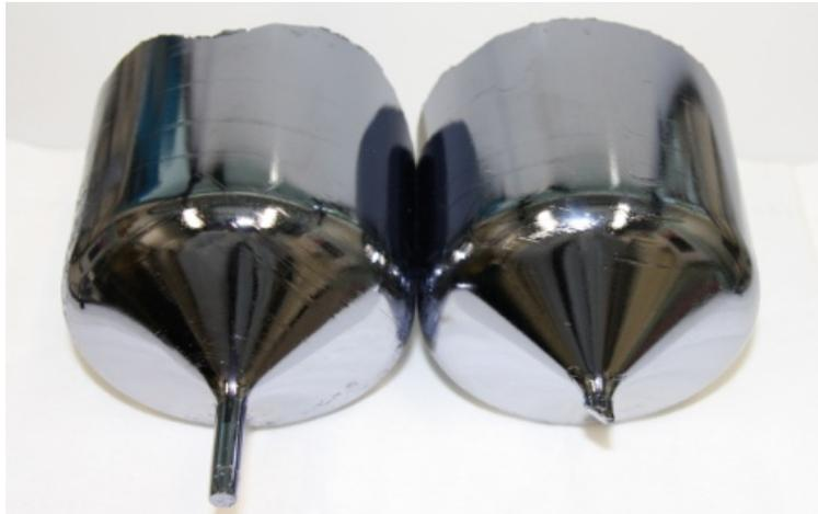
**Abb. 11:** Foto zweier GaAs-VGF-Einkristalle, gezüchtet im Multitiegel-Heizer-Magnet-Modul, Durchmesser 4 Zoll
