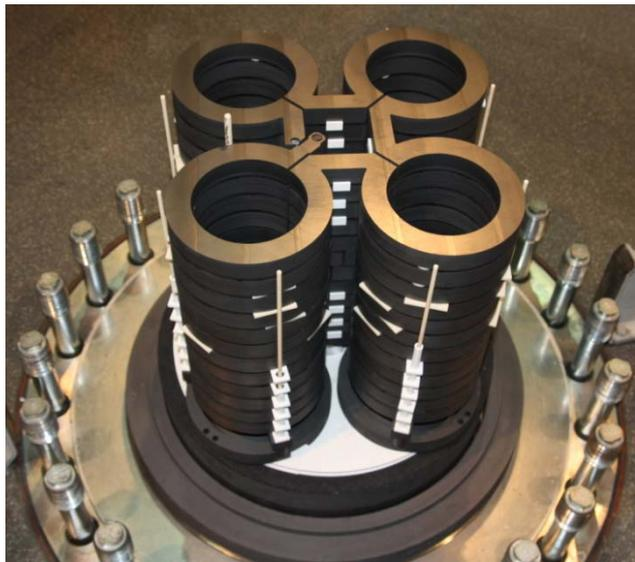
**Abb. 7:**Foto realisierter Multitiegel-Heizer-Magnet-Modulaufbau gefertigt aus Graphit für die Züchtung von 4 VGF-Kristallen mit einem Durchmesser von 4 Zoll
